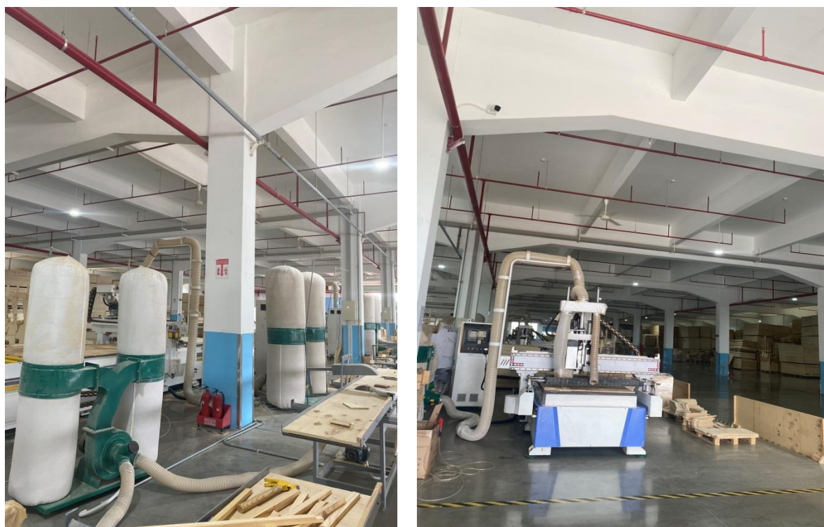
Hình 3.4. Hệ thống bộ lọc túi vải thu gom bụi gỗ tại Nhà máy
